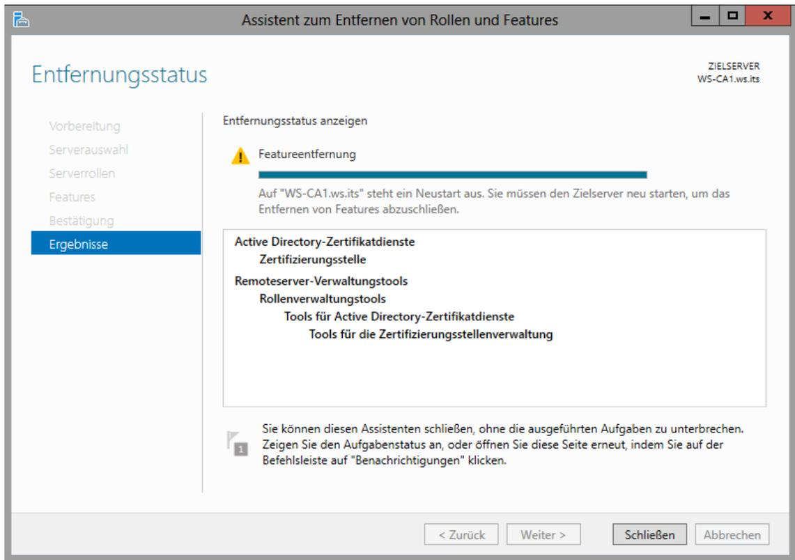
Nach dem Neustart kann der alte Server aus dem AD entfernt werden:
