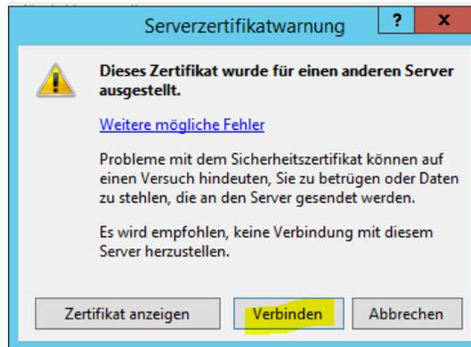
Die Verbindung steht. Aber es fehlt ein Webserver-Zertifikat. Dieses kann mit einer Zertifikate-MMC auf einem anderen Server angefordert werden. Sehr leicht geht das, indem man auf dem Management-Server ein Zertifikat mit dem richtigen Namen lokal anfordert, exportiert und dann auf dem Remote-Server importiert:
